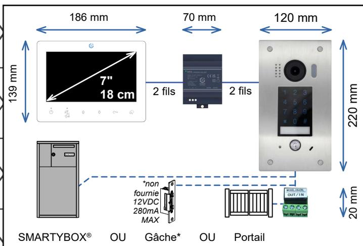
\*Pour plusieurs accès, en option Relais BUS multifonction selon usage *lini-RLC-C* en option (MINI-RLC-C, KDT-RLC-C, KDT-RLC-L ou KDT-RLC-RD)
